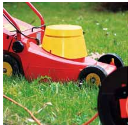
Fig. 3: esito fatale, soprattutto se manca l'interruttore differenziale
