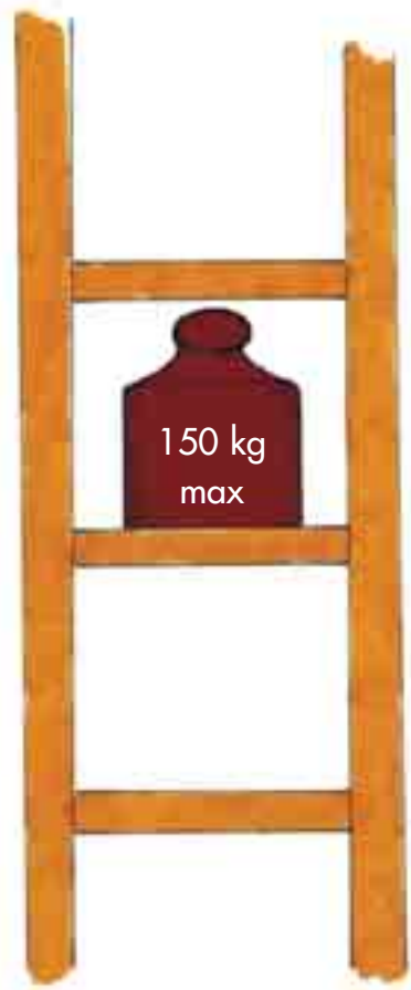
Fig. 27 - Peso massimo ammesso sulla scala
